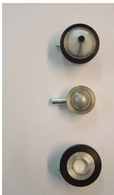
Port-filtres CIS , Button et IOM
