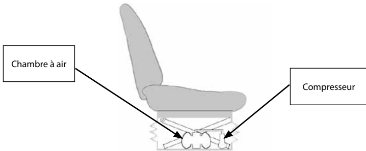
Siège à suspension pneumatique 5
