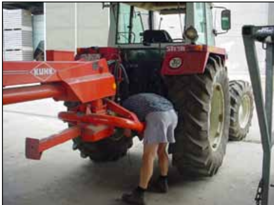
Les personnes proches du tracteur sont peu visibles du poste de conduite 12
