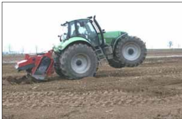
Tracteur se cabrant sous l'effet de la pente et de la charge attelée
