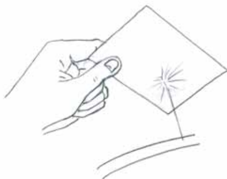
Détection de fuite sur un flexible hydraulique à l'aide d'un carton
