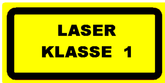
Mention de la classe apposée sur un appareil, conformément à la norme EN 60825.
