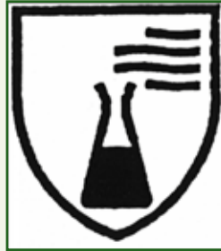
Figure 45 : Symbole indiquant la résistance aux produits chimiques
